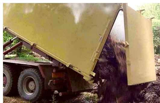
Figure 4 : Vidage du digestat en fin de cycle
